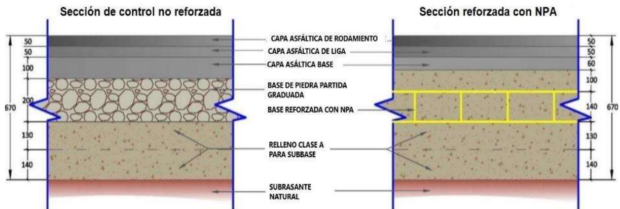
Figura 12. Comparación de estructuras. Convencional (izquierda) vs Base reforzada con NPA (derecha)
