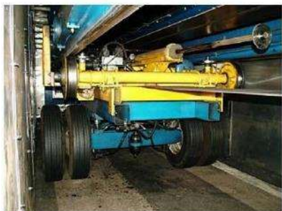
Ensayo de carga de rueda acelerada, U. de Kansas
