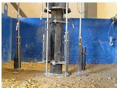
Ensayo de carga de plato cíclica, Univ. de Kansas
