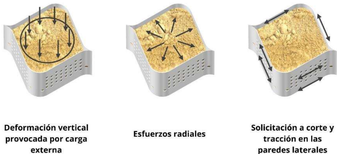
Figura 2. Derrotero de cargas en la geoceldas
