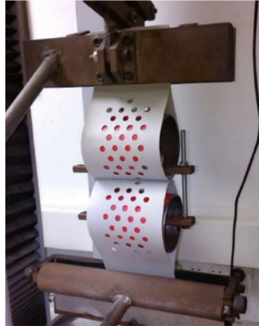
Figura 6. Sujeción de la geoceldas en ensayo de separación de costuras
